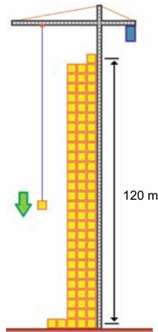
Suponha, por exemplo, que um bloco de 30 000 quilogramas esteja armazenado a uma altura de 120 m do chão. Sendo a aceleração da gravidade igual a  $10 \text{ m/s}^2$  e  $3600 \text{ J} = 1 \text{ Wh}$ , após esse bloco ser descido até o chão, desconsiderando perdas durante a transformação de energia potencial gravitacional em elétrica, a quantidade de energia elétrica convertida pelo dínamo será de
